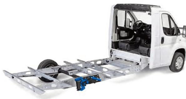
Kit disponibile per telaio ad asse singolo o doppio asse. Sistema composto da soffietti pneumatici e coppia di ammortizzatori per aumentare comfort e stabilità del veicolo.
